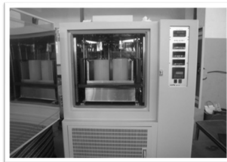
그림 1. 실내 동결 시험 장치
