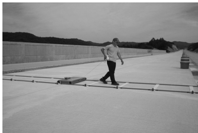
그림 6. 다웰바 시공상태 측정(MIT-SCAN2)
