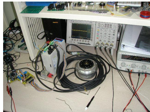
그림7. 테스트 중인 하모닉 모터와 모터 드라이버
