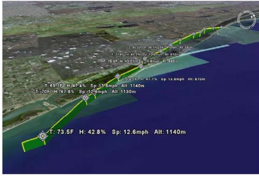
그림 4. 기상정보 모니터링 화면(온도센서, 습도센서, 고도, 위도, 경도 등)
