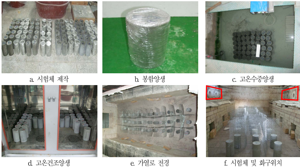
사진 1. 시험체 제작, 양생방법 및 가열로 전경
