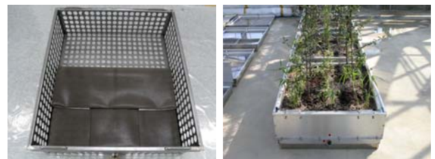
사진 4. 시험용 내부용기(좌)와 외부용기(우)의 형태
