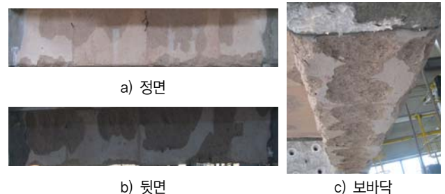
사진 3. ISO 온도가열 곡선에 따른 시험체의 폭렬 성상(보)
