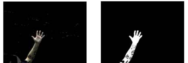
그림 4. 색차정보의 특징을 이용하여 피부색 검출과 이진화한 영상 (a) 피부색 검출 영상 (b) 이진화 영상
