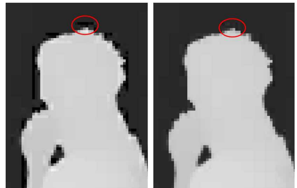
그림 5. Using H.264 DCT (left), Using MPEG-4 SA-DCT (right) (QP=36)
