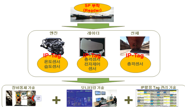
[그림 2] IP-RFID 기반 소형선박 관리 개념도
