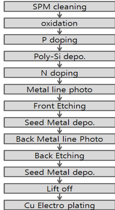
[그림 1] PV cell 제작 공정
