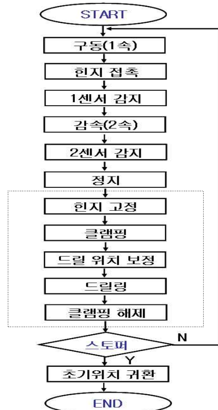
[그림 4] 자동 드릴링 머신을 이용한 작업 순서
