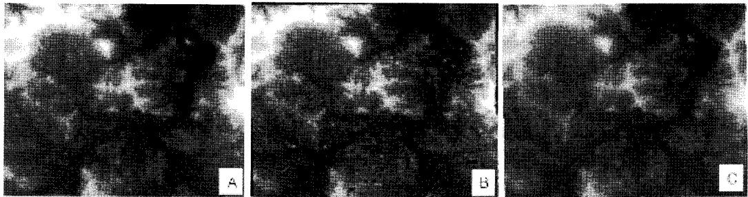
수정 전의 최하레벨 피라미드 영상을 보면 상당히 많은 공백 및 노이즈들이 존재함을 확인할 수 있으며, 알고리즘 적용 결과 이 오류들이 대부분 수정되었음을 확인할 수 있었다. 이를 확인 한 후, 단계 별로 DEM의 보정을 수행하였고 최종적으로 제작된 10m 공간해상도의 DEM은 다음의 그림과 같다.
