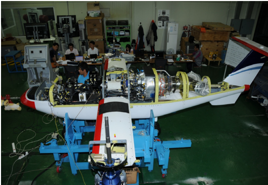
Fig. 1. 스마트무인기의 PW206C 엔진계통
