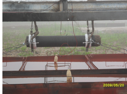
Fig. 3. 온도센서가 장착된 시험물
