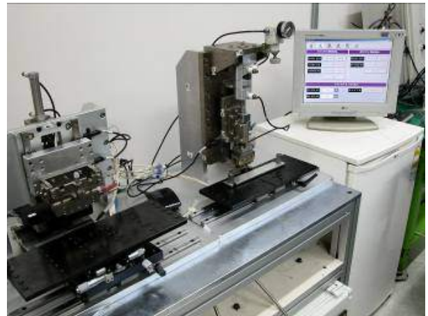
Fig. 2 COG Bonder(Pre/Main Bonding)
