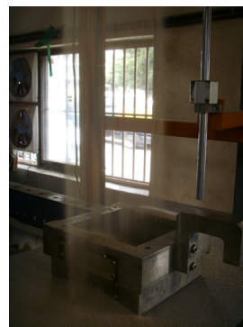
그림 7. 표준사를 전단상자에 뿌리는 모습
