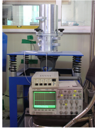
그림 4. 오실로스코프를 이용한 진동대의 진폭측정
