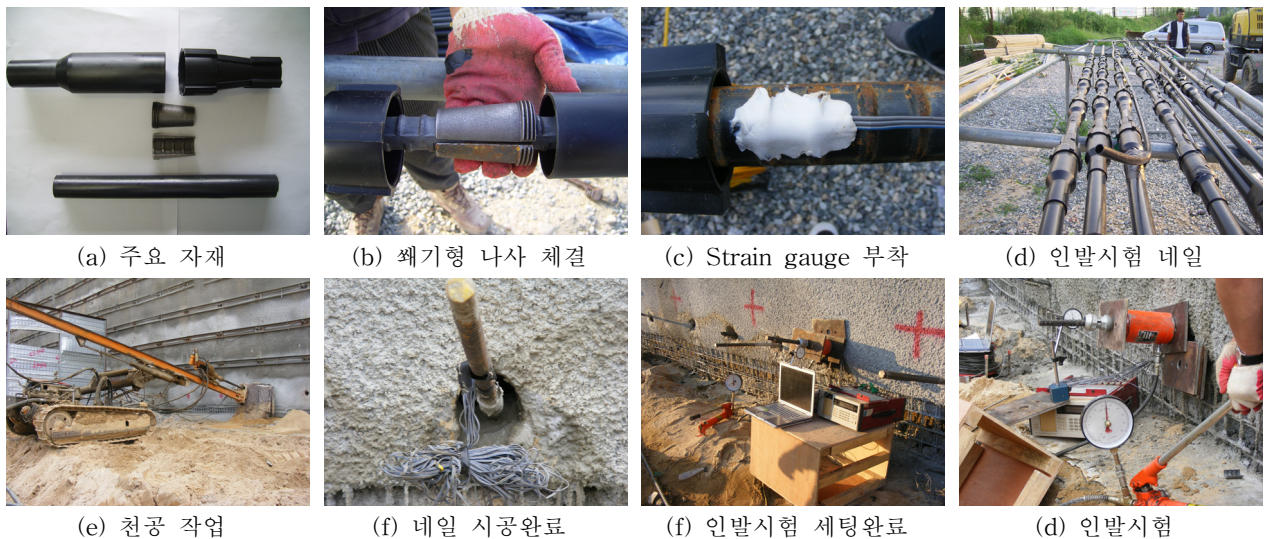
그림 5. 현장인발시험 과정
