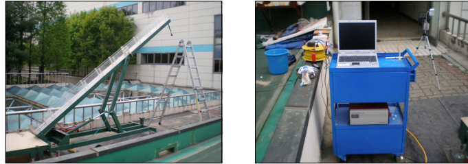
그림 1. 토석류 모형 실험(좌) 장치 및 데이터 로거(우)
