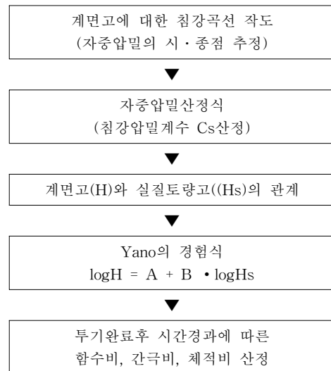
그림 4-3. 자중압밀 시험 분석 절차
