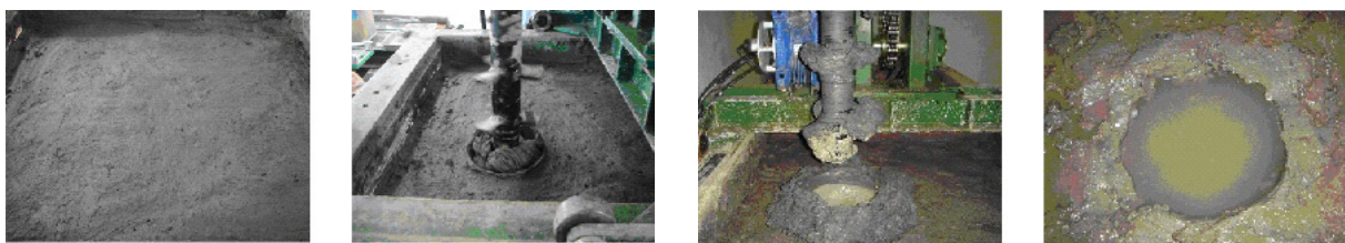
(a) 시료조성 (b) 교반축 토조 회전관입 (c) 혼화제 주입 및 인발 (d) 개량제 양생
