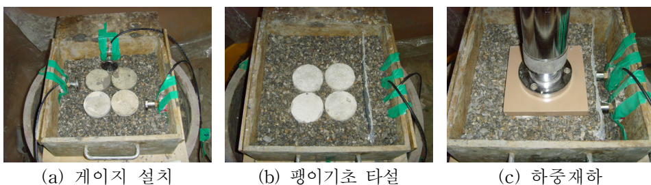
그림 7. 팽이기초 말뚝부에 작용하는 측방응력 측정
