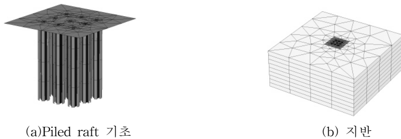
그림 15. Piled raft 기초 지지거동 예측을 위한 3차원 유한요소망
