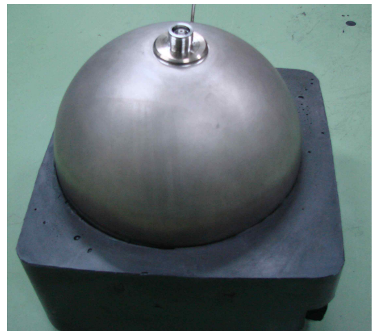
그림 1. 제작된 저선량 측정용 구형 이온챔버
