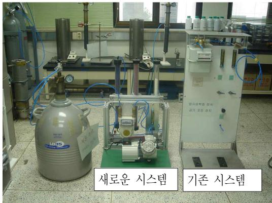
그림 2 기존 및 새로운 공기 포집시스템 비교
