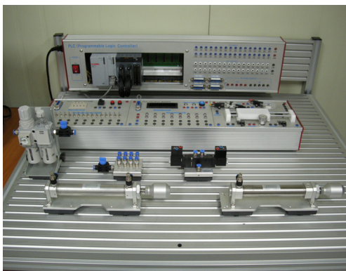
〈그림 1〉 PLC 기술교육 시스템
