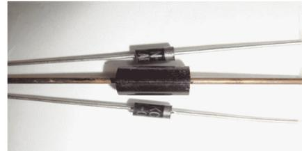
그림 7. 20mm와 12mm 구조셀의 PIN 다이오드 개별소자
