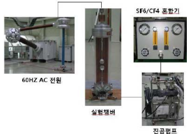
<그림 1> SF 6 /CF 4 혼합가스 실험 구성도(구-구 전극 간격 5mm)
