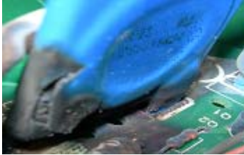
〈그림 3〉 열폭주 방지용 단로기와 협조가 없는 배리스터의 소손 사진
