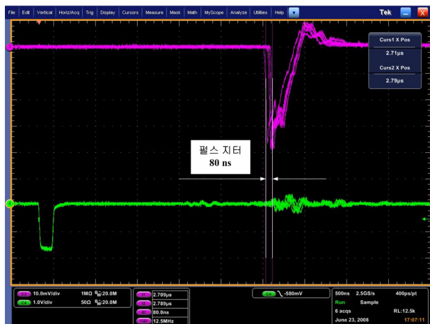
<그림 9> PFN marx 펄스 발생기의 지터 측정파형
