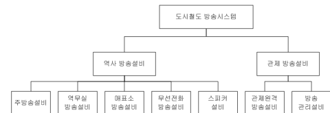
〈그림 4〉 도시철도 방송시스템 표준 하부 구성
