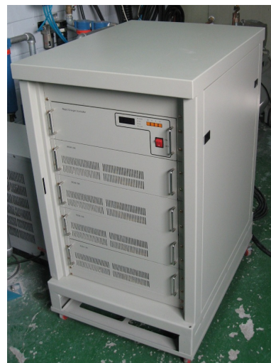
〈그림 3〉 제작된 4병렬 운전 급속 충전기(72V, 400A급)
