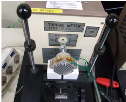
<그림 4> 펌프용 단상 BLDC Motor Test
