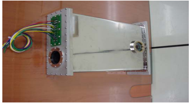
그림 2 펄스모드 X-선 발생 모노블록 탱크부
