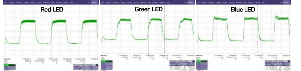
그림 6 Digital Dimming 시 RGB LED 각각에 흐르는 전류 파형 (50% Dimming 동작)
