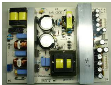
그림 7 400W급 LLC 공진형 컨버터의 실물사진 Fig. 7 Photographs of 400W LLC resonant converter
