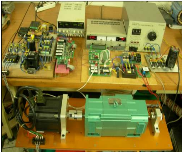
그림 2. 풍력발전 시스템 Fig 2. Wind power generation system
