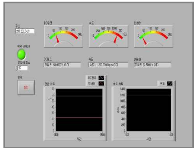
그림 5. 풍력발전 시스템의 모니터링을 위한 HMI Fig 5. HMI for the monitoring of the wind power generation system.
