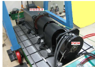
그림 14 부하시험 장치 Fig. 14 Load test bench
