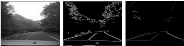
(a) 원영상 (b) 캐니에지 (c) 에지화소연결성 그림 2 에지 연결성을 이용한 차선 검출 영상
