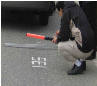
〈그림 13〉 소성변형 조사모듈 테스트를 위한 인력 측정 및 장비측정
