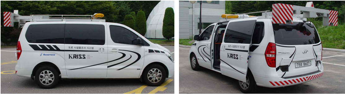
〈그림 4〉 도로포장상태조사장비(KRISS) 외형사진
