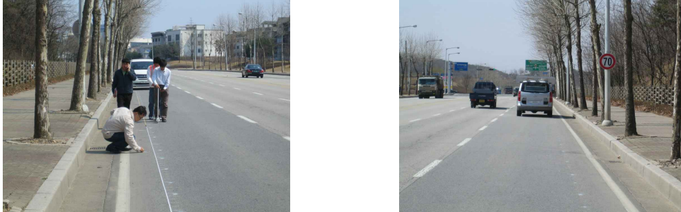
〈그림 14〉 종단평탄성 조사모듈 테스트를 위한 인력 측정 및 장비측정
