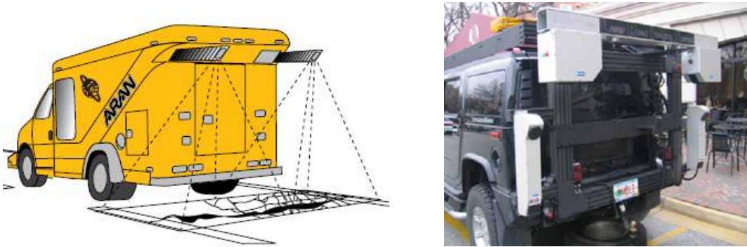
〈그림 1〉 표면결함(균열) 조사 방식(좌:Area Scan 우:Line Scan)
