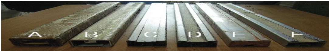
〈그림 3〉 지주프레임 보강 형태에 따른 실험 시편
