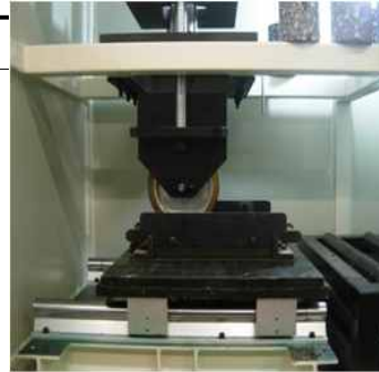
<그림 4> Wheel Tracking 시험사진
