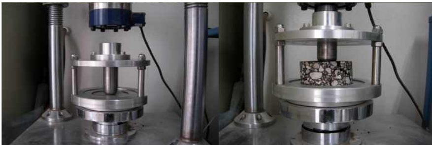
<그림 3> KIM Test 시험 모습
