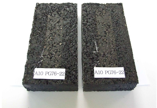
<그림 3> 2 Slab specimens for wheel tracking test
