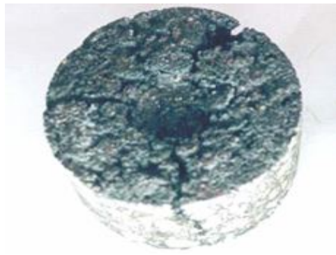
<그림 6> A typical failure shape of a specimen
