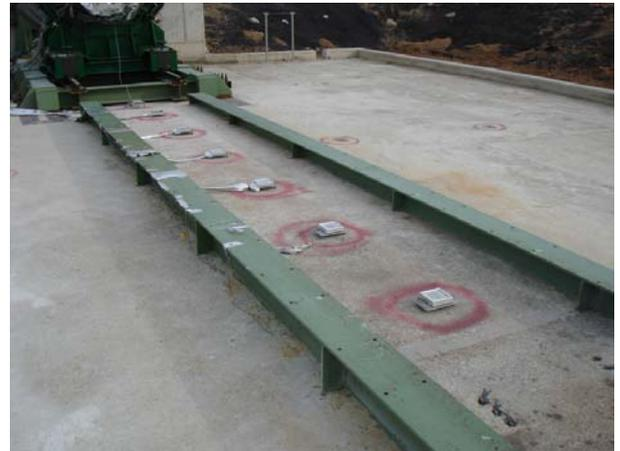
그림 5 축 방향 바닥면 센서 장착 장면
