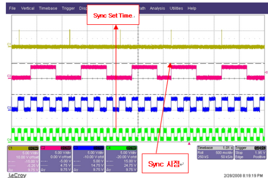
(그림 5) GPS 1PPS와 1, 4, 8Hz Pulse의 출력 파형
