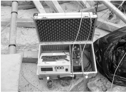
사진 1. 온도이력 측정기 설치
