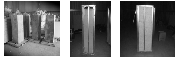
(a) 단주 시험체 (b) C-STUD 설치 (c) 단열재 설치
