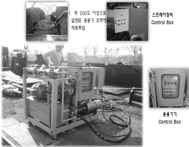
사진 1. 스프레이장비 시스템 현황(1)
