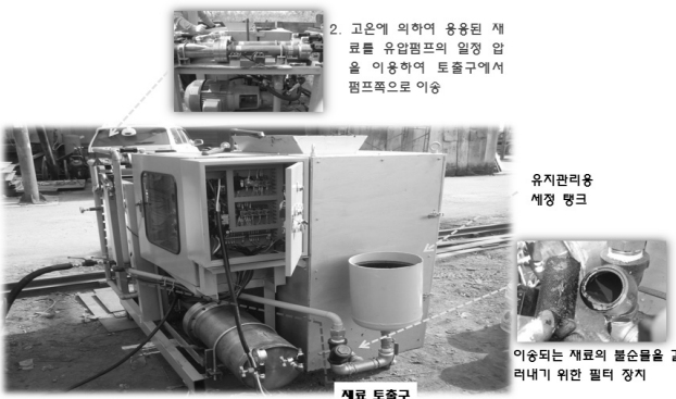
사진 2. 스프레이장비 시스템 현황(2)
